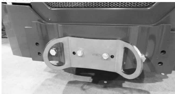
Surningsögla A418623 monterad på den bakre stötfångaren eller bakvikten
